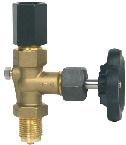
Absperrventil nach DIN 16270, Spannmuffe/Zapfen G 1/2, PN 250
