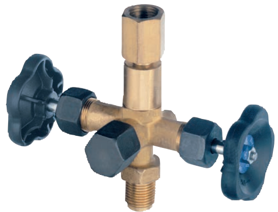
Absperrventil mit getrennt absperbarem Prüfanschluss nach DIN 16272, Spannmuffe/Zapfen G 1/2, mit Prüfzapfen M20 x 1,5, PN 400
